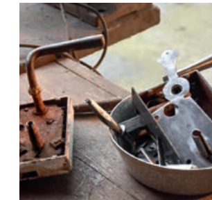
3. Die vielen aufpolierten Einzelteile des Kastenschlosses
